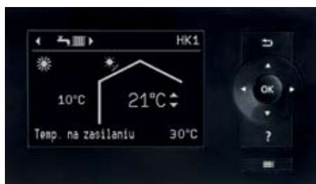
Wyświetlacz regulatora pompy ciepła Vitotronic 200
